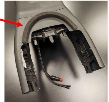
Setzen Sie die Mittelkonsole etwas versetzt nach hinten zwischen die Sitze und verbinden Sie die Zuleitung der Mittelkonsole mit dem Fahrzeug. Danach setzen sie die Mittelkonsole auf die Grundplatte. Durch die Langlöcher kann die Position auf die vorderen fixen Befestigungspunkte im Fußraum justiert werden.
